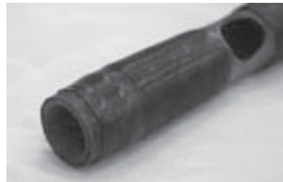
写真28 青海波 錘を挿入するしくみ
