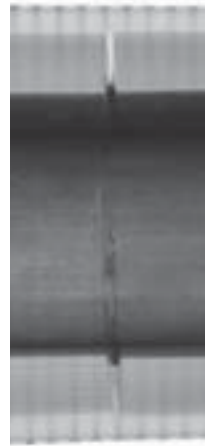
写真3 木枯 竹の亀裂
