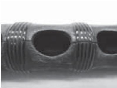
写真14 白雲 指孔の亀裂
