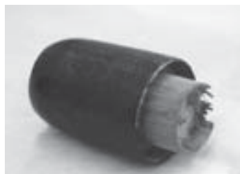
写真28 青海波 錘を挿入するしくみ
