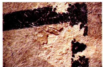
写真15 木材に打ち込まれた金属の杵(x5.1)
