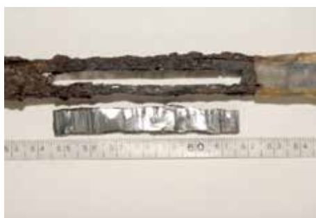
c. 分析試料(金属鉄)の切り出し
