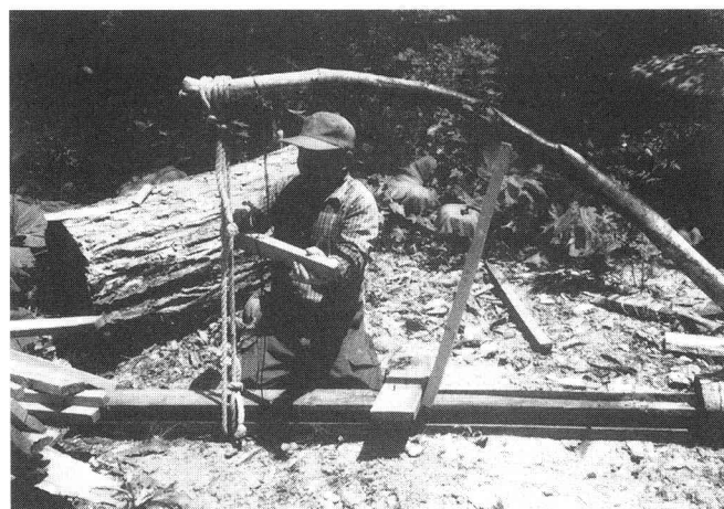
写真17 柄の曲がりの角度の固定 柄の曲がりの角度を決め て固定し、数ヶ月放置する。
