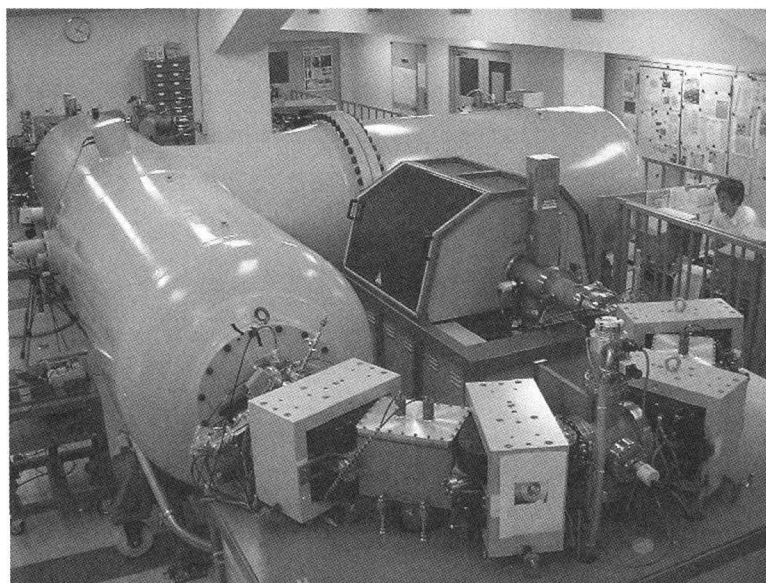
写真1 名古屋大学年代測定総合研究センターに設置されているタンデトロロン加速器質量分析計 ( 14 C測定専用AMSシステム)
