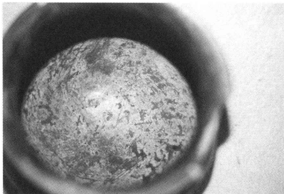
写真 21 樹脂摩耗(使用段階 1)
