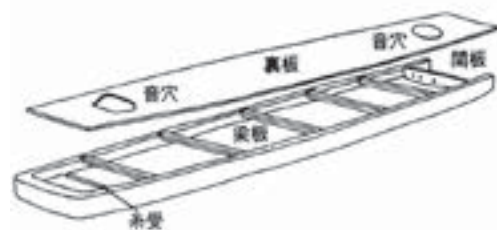
図1 現行の箏の内部構造
