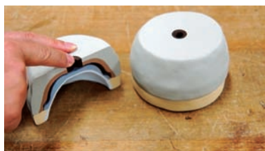
圖 9 整體模具模型和 中心斷面示意模型
