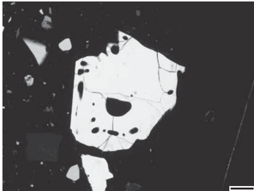
3 融食を示す単結晶石英粒子 (中央), 山崎北遺跡 KEK-138, 直交ポーラ
