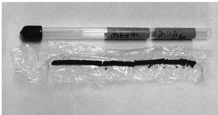
写真4-1 光谷拓実氏により採取された柱根 SP15301 年輪コア試料 (#1) コア径は5 mm でコア長は約17 cm あり、右方向が外側である。後方 (写真上) は試料容器。
