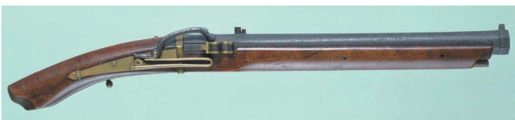
図版 9 田布施流の鉄炮 (口径 15mm・全長 98cm 銘「摂州住藍屋権右衛門作」) (歴博所蔵) 地板、前目当が仕様が田布施流秘伝書に合致する。
