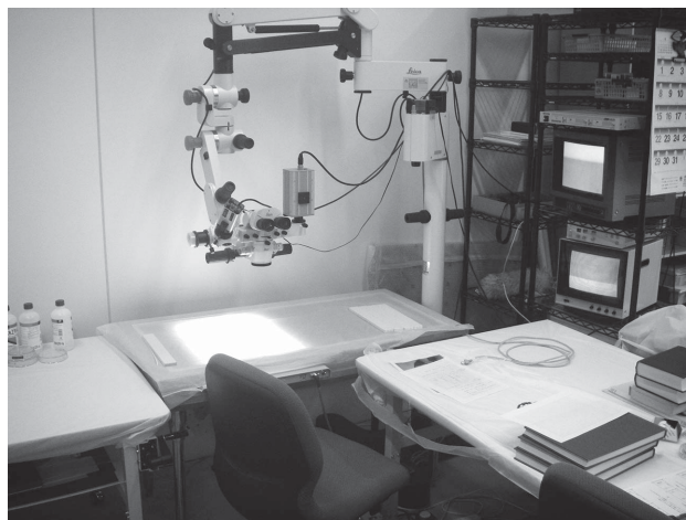
写真6 正倉院事務所の古文書観察システム 顕微鏡・透過光・赤外線による観察を行う
