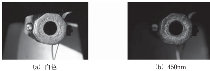
図10 銃口部を法科学用光源の白色光及び450nmフィルタで照明し、カラーデジタルカメラで撮影した画像 (論文末カラー図参照)
