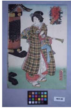
図14 図4(a)に示すNEX-BEタイプの の蛍光灯で照明し、カラーデジタル カメラで撮影した錦絵画像
