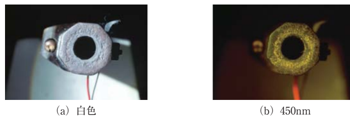
図10 銃口部を法科学用光源の白色光及び450nmフィルタで照明し、カラーデジタルカメラで撮影した画像
