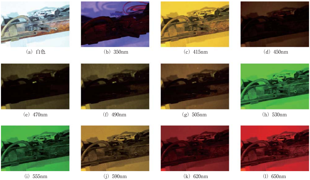
図9 法科学用光源に装備されているフィルタを用いて照明し、カラーデジタルカメラで撮影した画像
