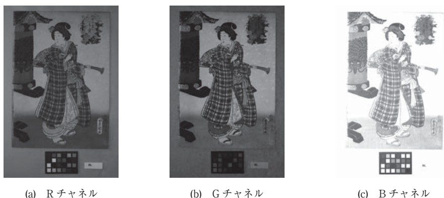
図17 図16(b)に示すカラー画像のRGBチャンネル分解画像
