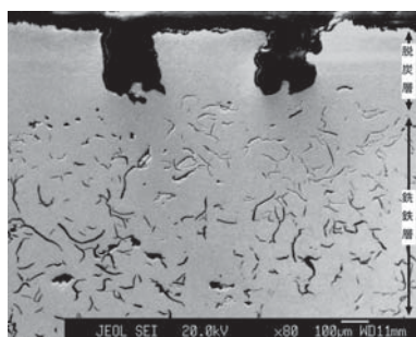
図9-3a 1000°Cで30分加熱したテストピースの金属組織
