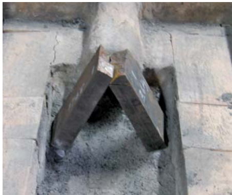
c. 羽口の取り付けと火槽の成形
