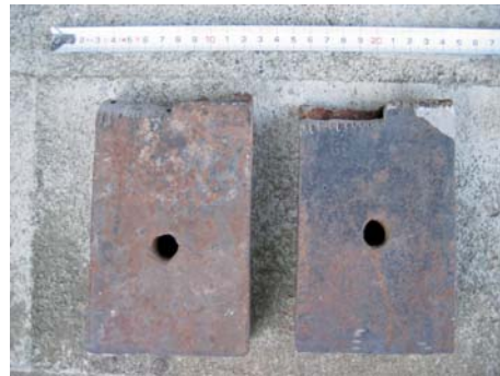
b. 原料(肘金を切断したもの)
