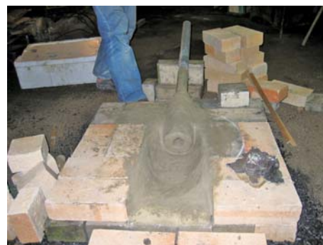
b. 羽口の取り付けと火窪の成形
