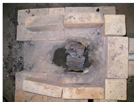
b. 原料の設置状況(上から)
