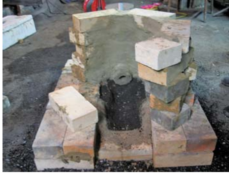
a. 構築途中の炉
