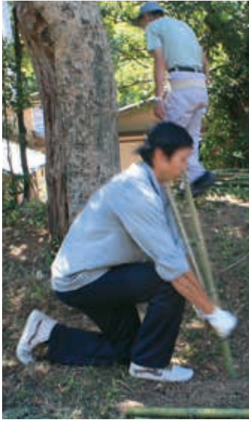
11-28,29 金具の凸部をタケの中心にあて、そのままタケを地面に叩きつけると勢いで6面に割れる。節の部分などの微調整はのちほど行う
