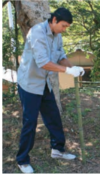
11-28,29 金具の凸部をタケの中心にあて、そのままタケを地面に叩きつけると勢いで6面に割れる。節の部分などの微調整はのちほど行う
