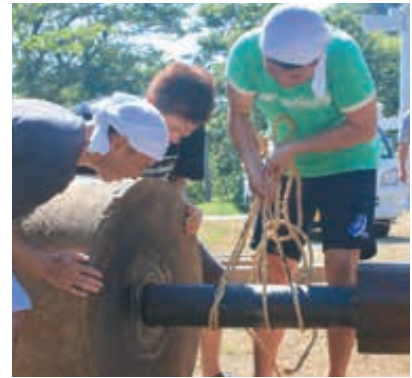
10-3 ワラ縄で車軸部を持ち上げ、適当なところで、車輪を押し入れる
