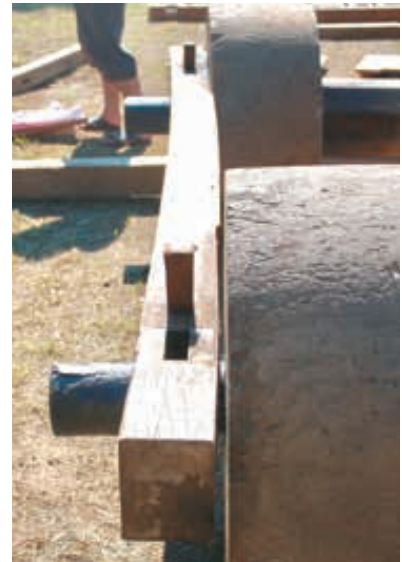
10-5 車輪の外側にも横柱をすえ、木釘で固定する
