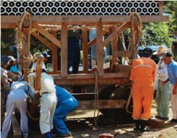
11-5 短めに縛ったロープを道具を使って車軸に通し、ネジンをカいていく 左側では前後のネジンを車軸に通している
