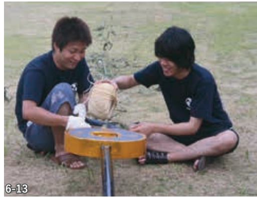
6-12,13 上はタケにゼニガタの棒を突き入れた状態。 下は突き入れた部分をナイゴで補強している
