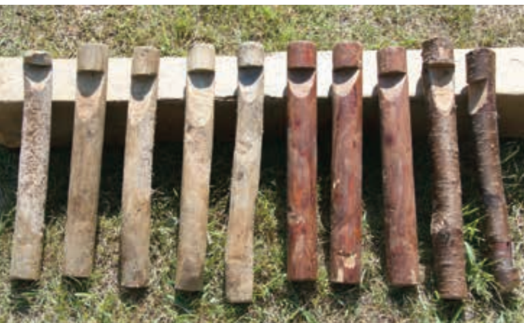
11-2 倉庫に保管されているネジン棒。ケヤキの枝を使うとされるが、右端の2本はサクラの枝によるものである。凹みを入れた部分にロープをかませてねじっていく
