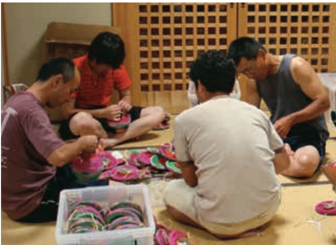
5-15 提灯の底部を補強する作業
