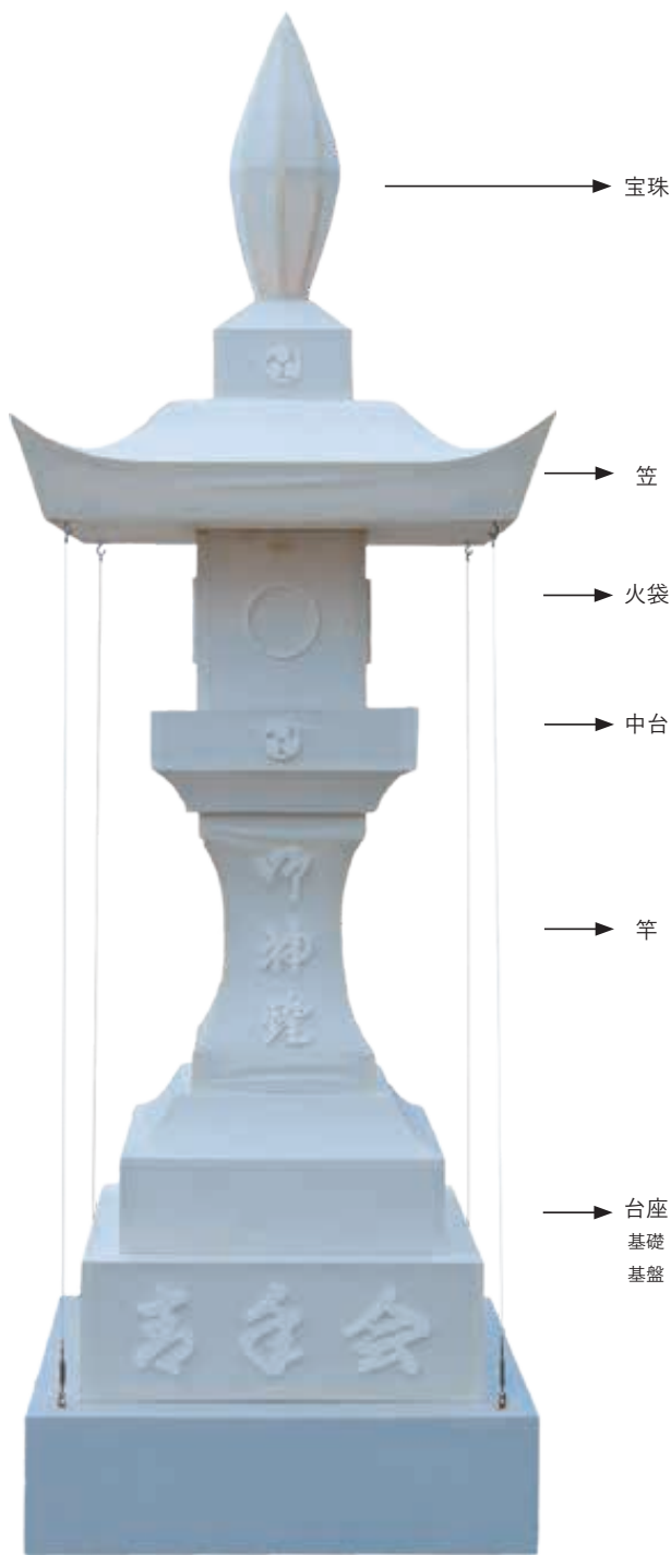
2-17 現在の奉灯の正面図。各部の取り外しは可能だが、ほとんど取り外すことはない。火袋の火窓の位置は、宮の灯笼の形式に準じる
