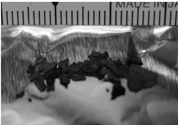
写真3 分析に供した漆棺の微小片 (スケール: 1mm)
