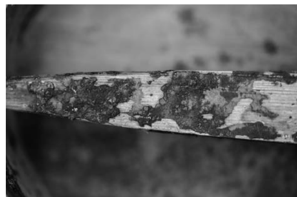
写真11-4 柄杓柄部分に付着固化した塗料の状態
