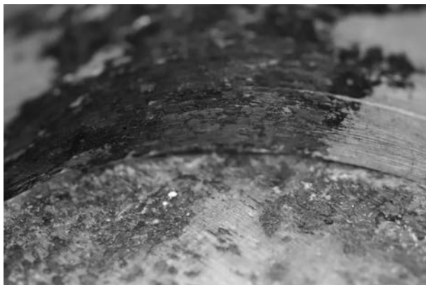
写真11-1 内部側面・底面に付着固化した塗料の状態
