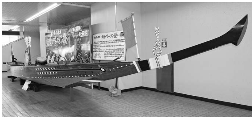
写真5 兵庫県相生のペーロン 新幹線相生駅コンコース 2018年 上タナと下タナの接合部、ミヨシとタナの接合部の釘頭に漆喰が塗られている。この場合釘頭は浅い。長崎で建造された。
