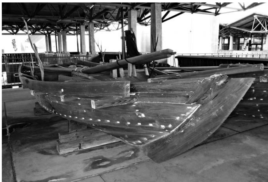
写真6 サツマ型漁船 熊本県牛深 うしぶか海彩館 2017年 ペーロンと同様上タナと下タナの間、ミヨシとタナの接合部の釘頭に漆喰が塗られている。ハギ目にも塗られている。
