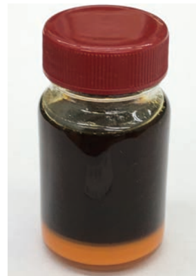
図 31 完成した高森観好の処方の固着剤 (司馬江漢の処方に近似すると考えられる)
