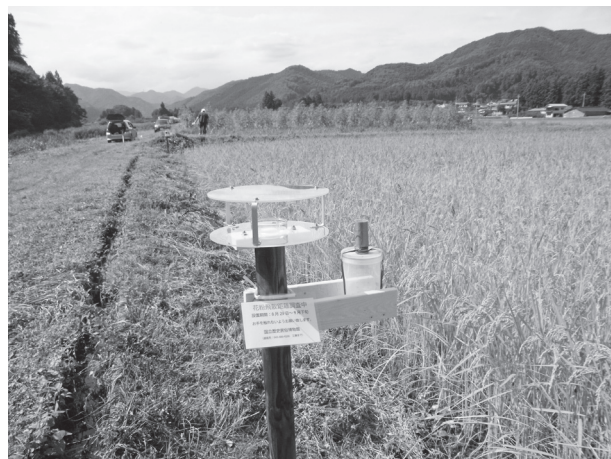
10. アサ花粉トラップの設置状況 (2011年度, 栃木県鹿沼市)
