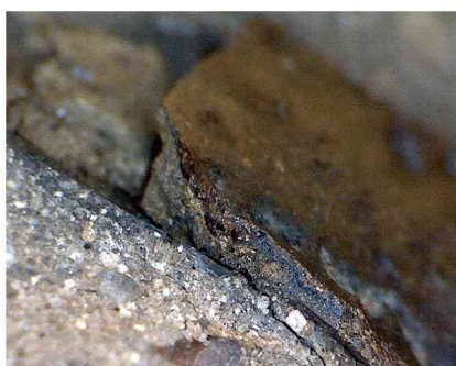
38. 調査区Ⅱ D9-318 土混漆接合 外面は土混漆を塗り込めた後、黒色漆 と生漆を塗り重ねている
