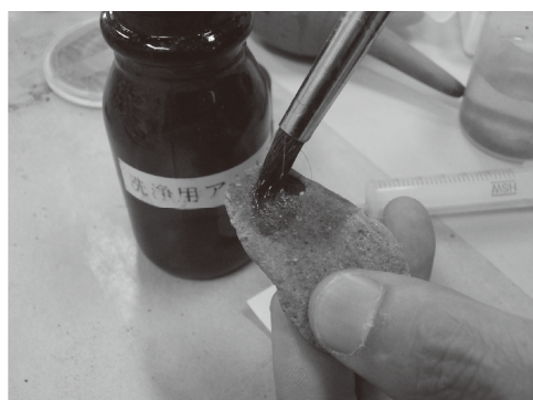
6. レプリカの取り外しと 離型剤の洗浄 全体の光沢がなくなるまで、アセトンで 洗う。
