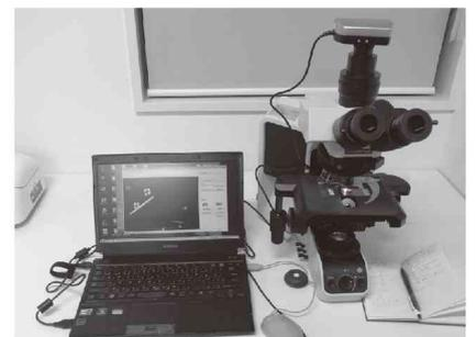
③ 光学顕微鏡で観察 (2010年9月採取試料: Nikon ECLIPSE E600, 2011年2月採取試料: Olympus BX53-33Z, どちらも簡易偏光装置付)
