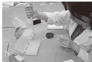
② 試料の採取箇所に精製水を含ませる
