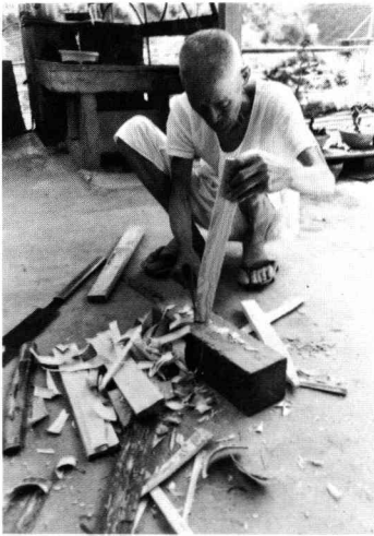
(1) ヨキでヒノキの平板の先端を尖らす。
