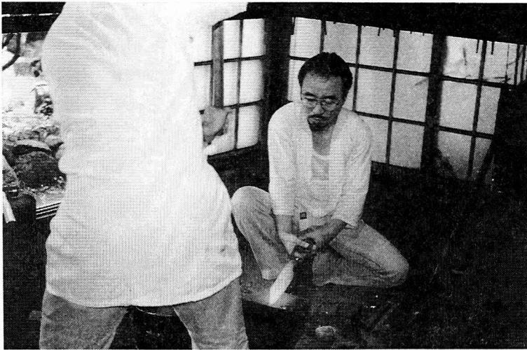
写真19 ギボン隕鉄からナイフを造る実験
