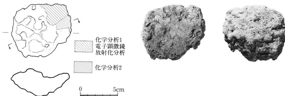
図46 三浦遺跡出土鉄滓サンプリング位置図, 写真 (縮尺1:3)
