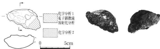
図38 漆町遺跡出土鉄滓サンプリング位置図、写真（縮尺1：3）
